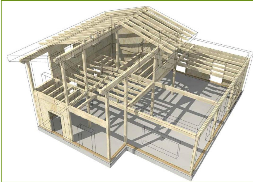
Il sistema prevede la realizzazione di una gabbia strutturale con elementi travi e pilastri a sezione quadrata o rettangolare, uniti tra loro attraverso carpenterie metalliche ed elementi metallici di collegamento quali viti, bulloni e piastre sempre in acciaio.
