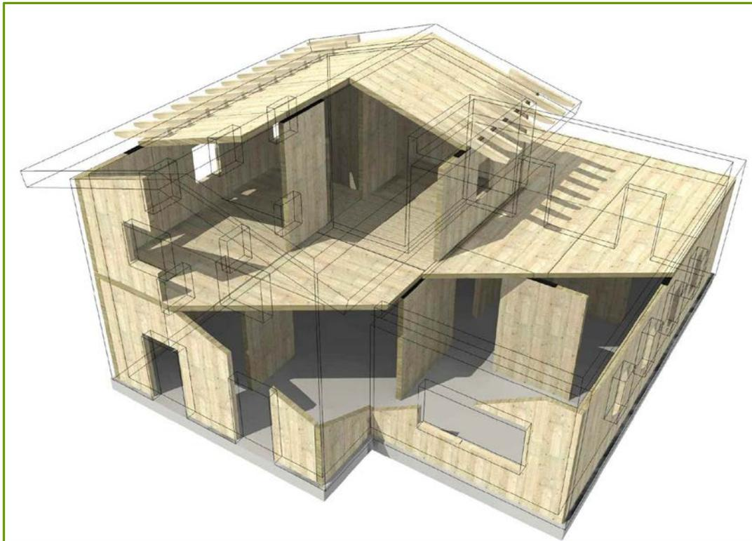
Realizzato da setti in legno massiccio a strati di tavole sovrapposte e disposte ortogonalmente fra loro collegate mediante chiodatura o incollaggio.
