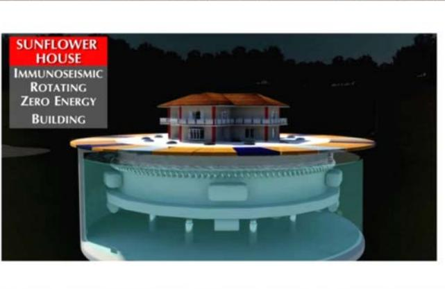
Nella vasca si riversa il flusso dell'acqua scaldata continuamente dai pannelli solari e l'energia termica accumulata scalda l'edificio.
