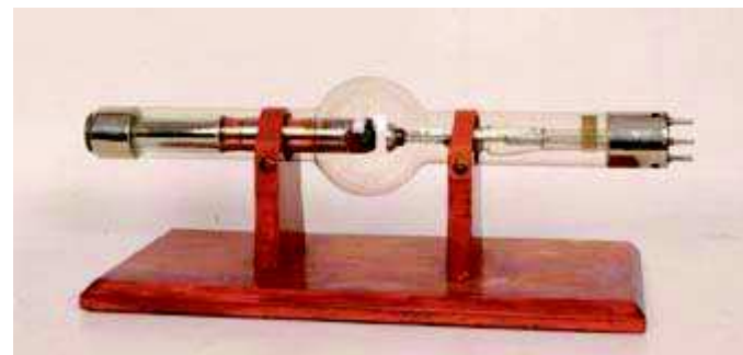
Raggi X-Tubo di Coolidge, 1913
